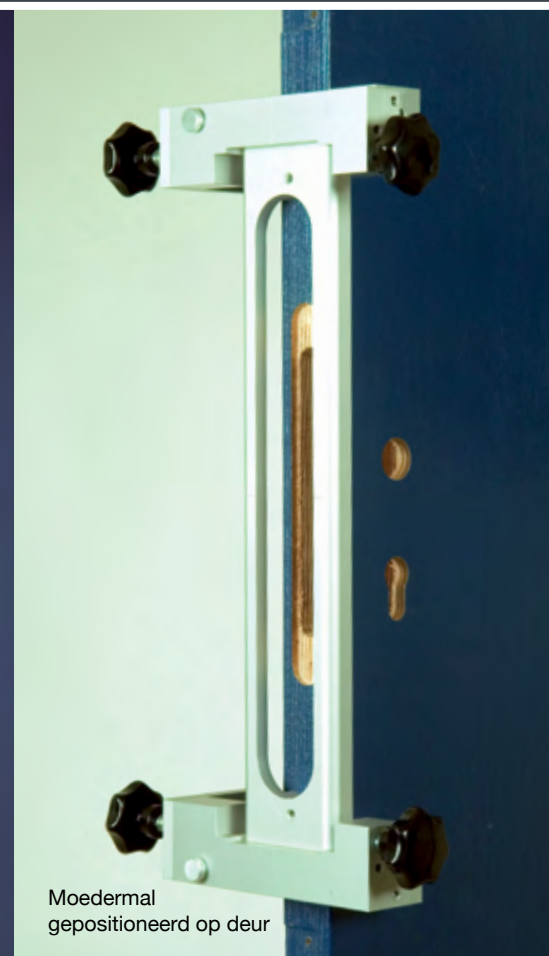
Verstelbare U-cassette voor alle type sloten
